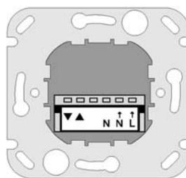
Přívod sítě - fáze (L →)
