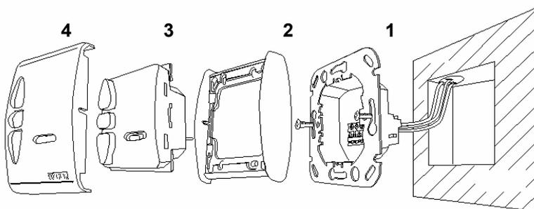
Řídicí jednotka **Centralis UNO RTS VB** je určena pro montáž do instalační krabice pod omítku o  $\varnothing$  60 mm anebo do odpovídající krabice na omítku.
