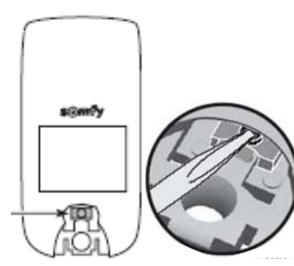
Keytis NS 4 RTS umístění tlačítka "PROG"
